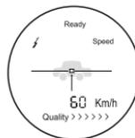
**Примечание:** точность измерения зависит от угла между пользователем и объектом: чем меньше угол, тем выше точность. Для повышения точности измерения рекомендуется сделать 3-4 замера подряд и вычислить среднее значение.
