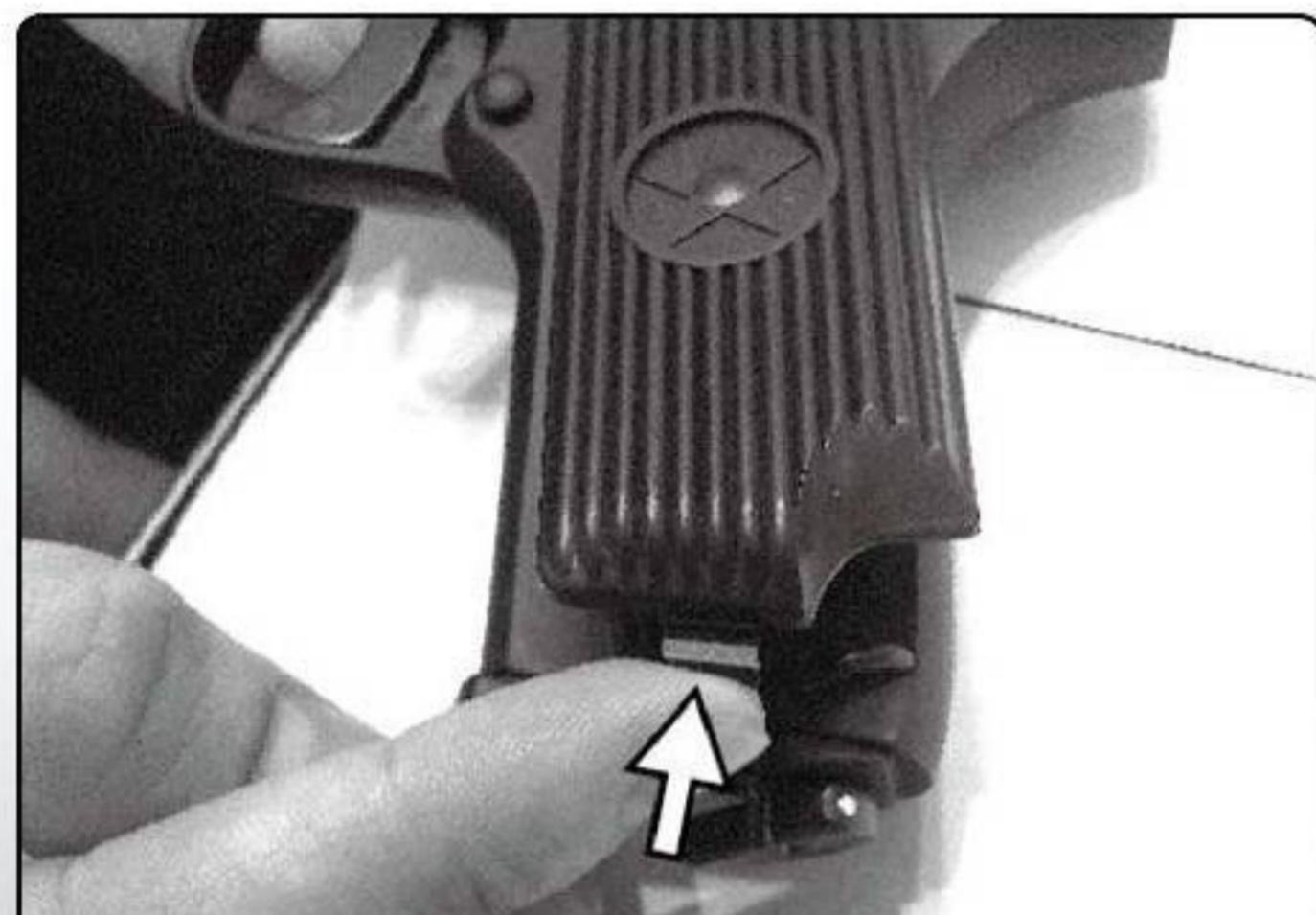
1. Поднимите левую накладку рукоятки для установки нового баллона CO2.
